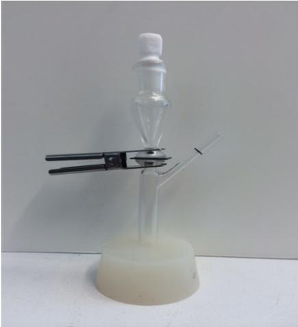
**Figure 3:** Diffusion Cell Setup
