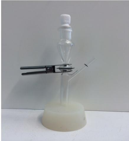
**Figure 3:** Diffusion Cell Setup
